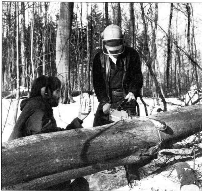
图1.4. 利用一个加速度计和一台振动计测量由链锯手柄传出的振级
